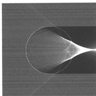
Abbildung 3: Simulierte Lichtstreuung an einem kugelförmigen Tropfen.  $2 \cdot 10^4$  Lichtstrahlen wurden am linken Bildrand auf einer zufällig gewählten Höhe abgeschossen. Die Strahlen wurden an der Grenzfläche Luft/Wasser in zufälliger Weise entweder reflektiert oder transmittiert (mit einer Wegwahl entsprechend dem Reflexionskoeffizienten). Die Helligkeitswerte (8 Bit) wurden sukzessive aufaddiert. Das Bild hat eine Kantenlänge von 600 Pixeln.
