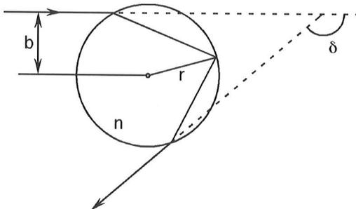
Abbildung 2: Der kugelförmige Wassertropfen hat Radius  $r$  und Brechungsindex  $n$  relativ zur Umgebung. Der Ablenkungswinkel  $\delta$  ist eine Funktion des Stossparameters  $b$  und der relativen Brechzahl  $n$ . Er lässt sich leicht mit Hilfe des Reflexions- und Brechungsgesetzes bestimmen.
