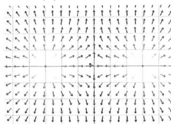
Ce logiciel permet de travailler plus généralement sur un champ électromagnétique. Différents objets sont à disposition de l'utilisateur : charge positive, charge négative, groupe de charges, canon à électron, barre chargée, condensateur, fil électrique, solénoïde, écran, plaque chargée, champ électrique uniforme, champ magnétique uniforme.
